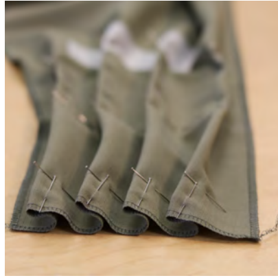
9 | Damit die Culotte auf Taillenhöhe auch den gewünschten faltigen Bund erhält, werden dafür Abnäher gesteckt und anschließend genäht.
